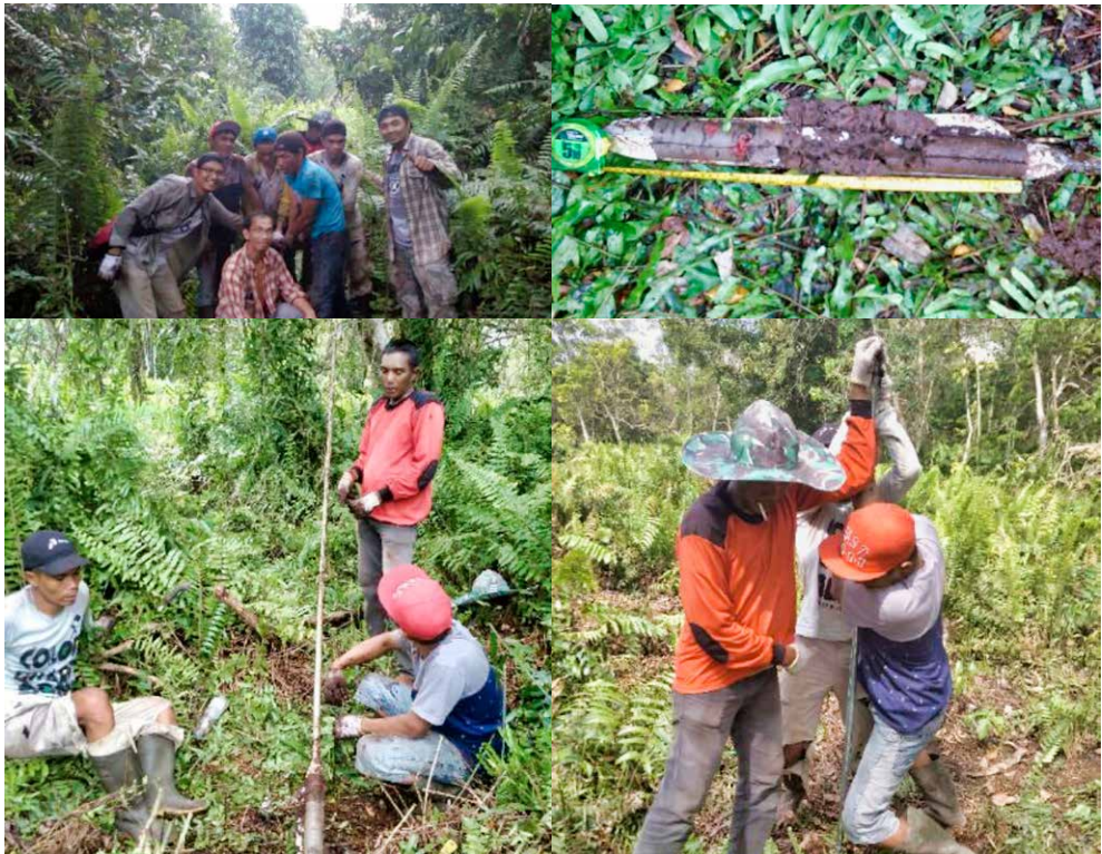
Gambar 4.10 Pengukuran kedalaman dan pengambilan contoh gambut.
