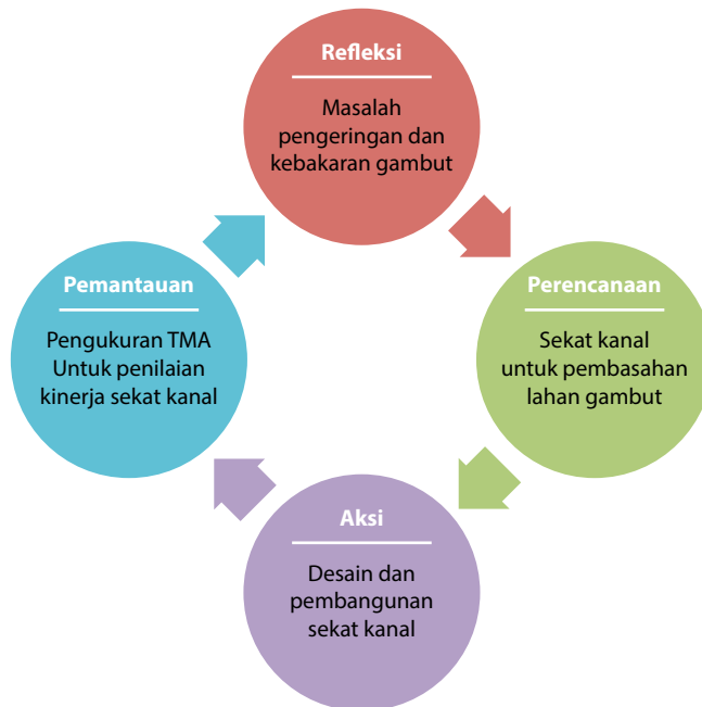
Gambar 4.1 Tahapan proses dalam RAP untuk pembangunan sekat kanal dalam penanggulangan masalah pengeringan dan kebakaran ekosistem gambut.
