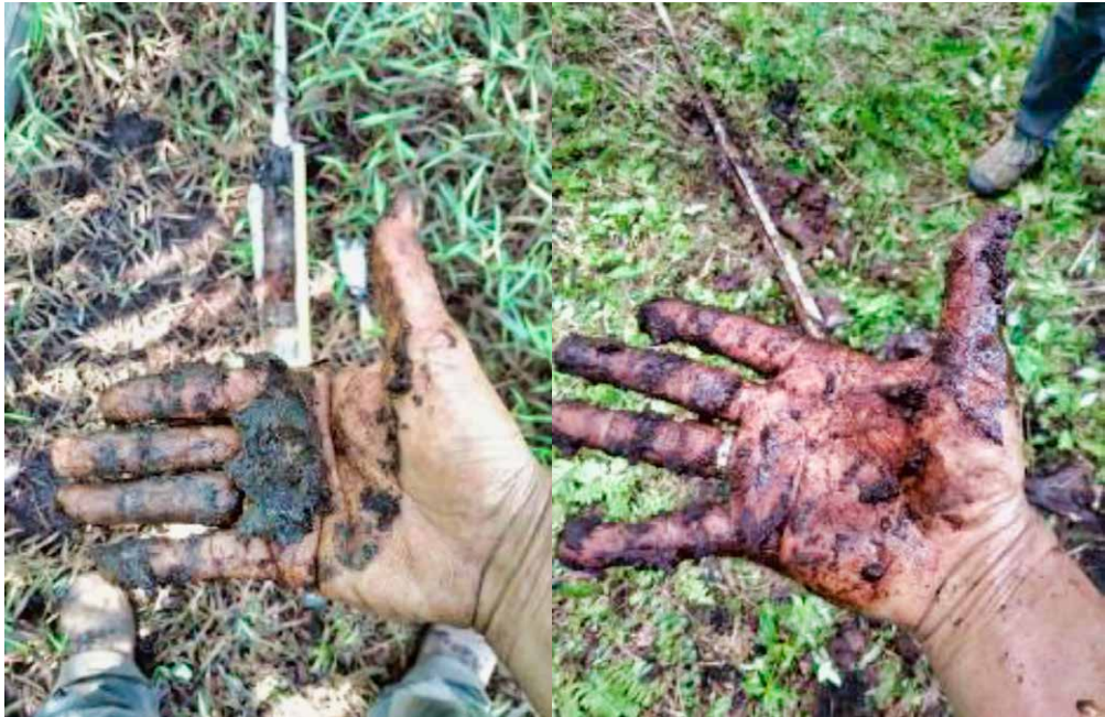
Gambar 4.9 Pengukuran kualitatif tingkat pelapukan gambut: hemik atau pelapukan gambut sedang (kiri) dan saprik atau pelapukan gambut lanjut (kanan).
